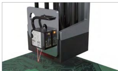
安装部件高度检测
