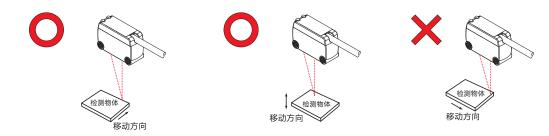
• 另外, 检测物体的颜色、材质有极端变化时, 如下图进行安装。
